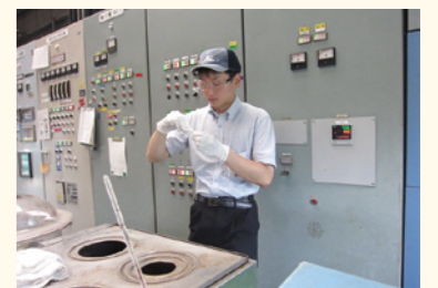
放流水フェノール簡易検査
