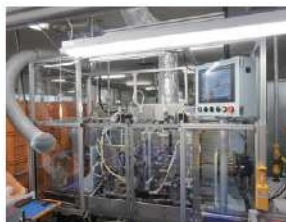
独自仕様の電動式熱風溶着機
