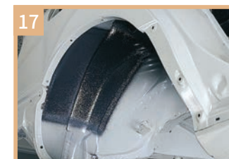
17 アンダーコート 石跳ねからボデーを守るために塗られるアンダーコート PVC-free Underbody Coating PVC-free undercoat to protect body from stone chipping
