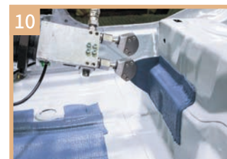
10 塗布型制振材 フロア部に塗布することで振動騒音を低減し、車室の静粛性を向上させる制振材 Liquid Applied Sound Deadener Applied on floor to reduce vibration and improve cabin silence
