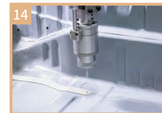
14 ボデーシーラー (低VOCタイプ) 板合せ部に水密、防錆を目的で施工されるシーリング材 Body Sealer (Lower VOC type) Sealant for steel joint for water seal and corrosion protection
